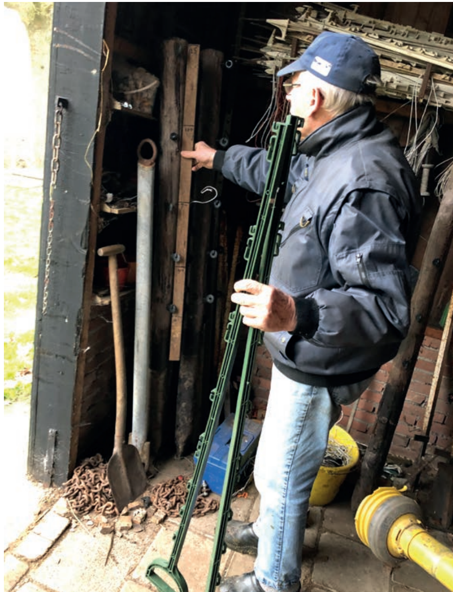
➤ Koop heeft een meetlat gemaakt, zodat hij weet hoe ver de palen de grond in moeten en op welke hoogte de vijf draden moeten komen.
